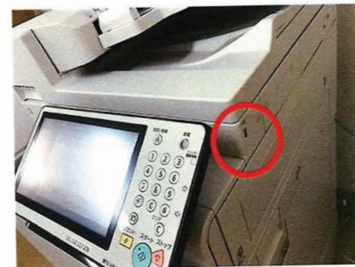
USBメモリスティックを側面に差し込む
